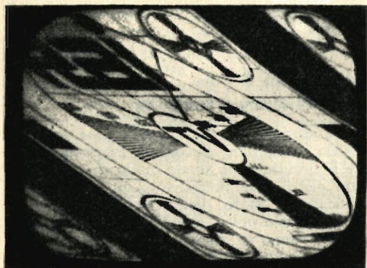
Fig. 5 - Perdita contemporanea dei sincronismi orizzontale e verticale.
