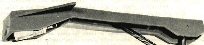
Fig. 8 - Il braccio del giradischi risulta già montato in tutte le sue parti essenziali; il compito del lettore è quello di fissarlo sulla faccia anteriore della piastra metallica.
